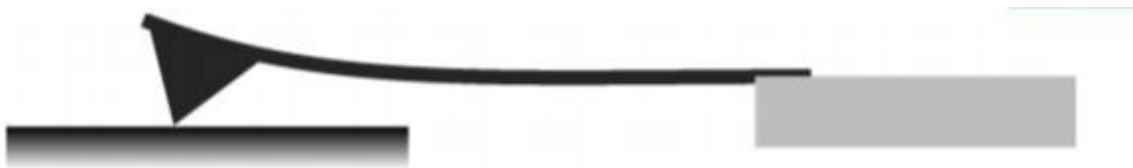
شکل ۲-۶. تصویر مد تماسی یا استاتیکی
