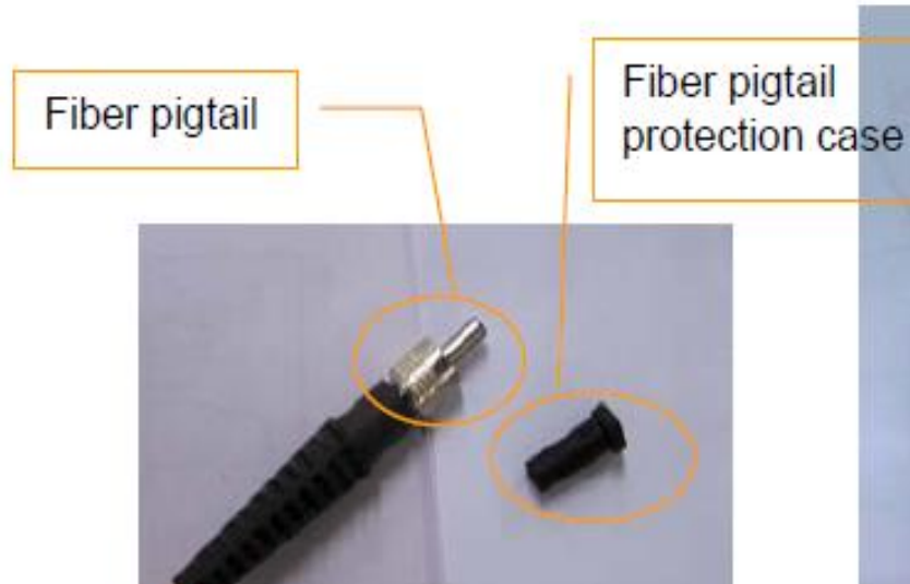
شکل ۱-۲. تصویر پیگتیل و درپوش فیبر لیزر
